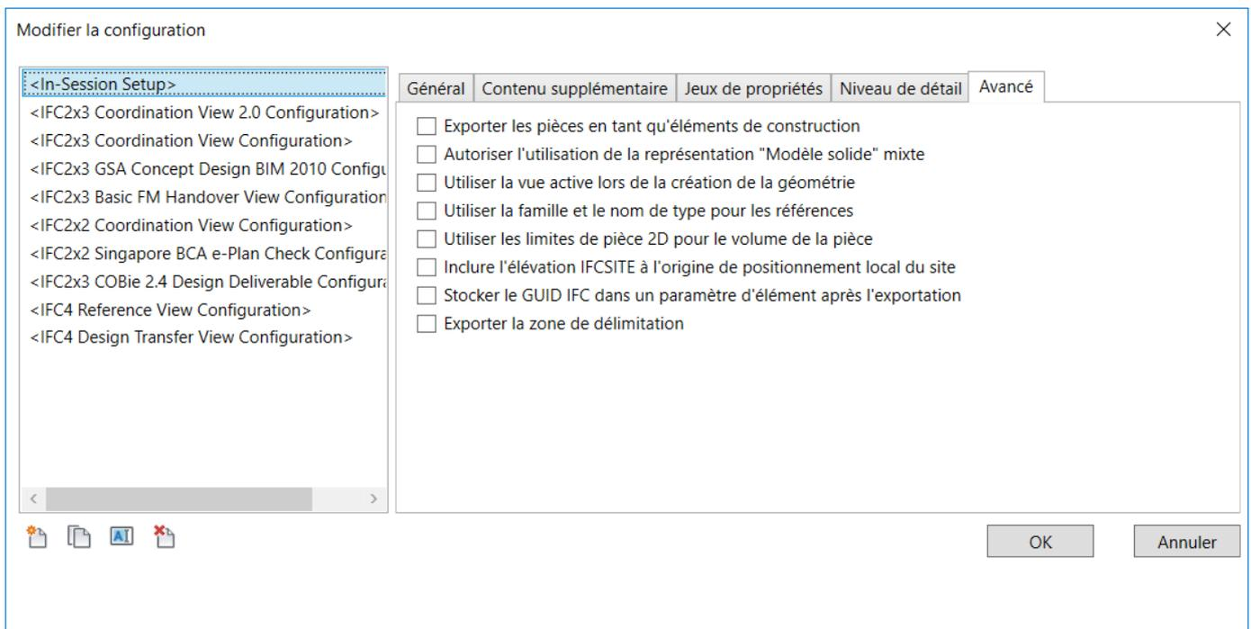
**Exporter les pièces en tant qu'éléments de construction** est une option conçue pour l'échange de données IFC lorsque des éléments partiels sont utilisés dans la construction de murs ou de dalles. Les éléments partiels sont exportés en tant qu'éléments `IfcBuildingElementPart` par défaut, ce qui permet d'affecter des pièces individuelles à un élément de niveau supérieur dans le modèle de données IFC :
